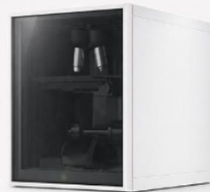
(4) サーモリフレクタンス 熱物性測定装置 (薄膜・微小粒子・ 微小構造の熱伝導)
