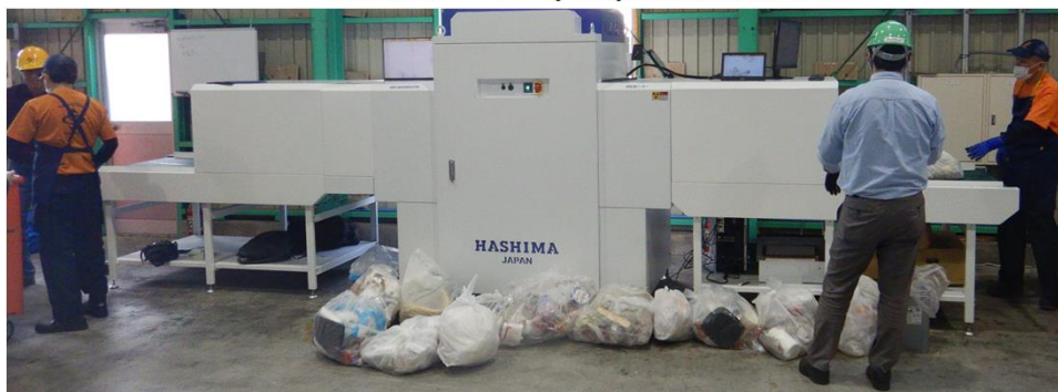
OSLiBソーター(TM)の本体と実証実験風景
