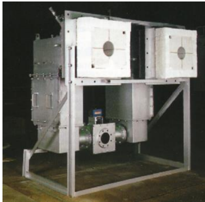
(ハニカム型)蓄熱式燃焼システム
