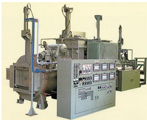
(加圧ガス冷却式3室型)真空炉
