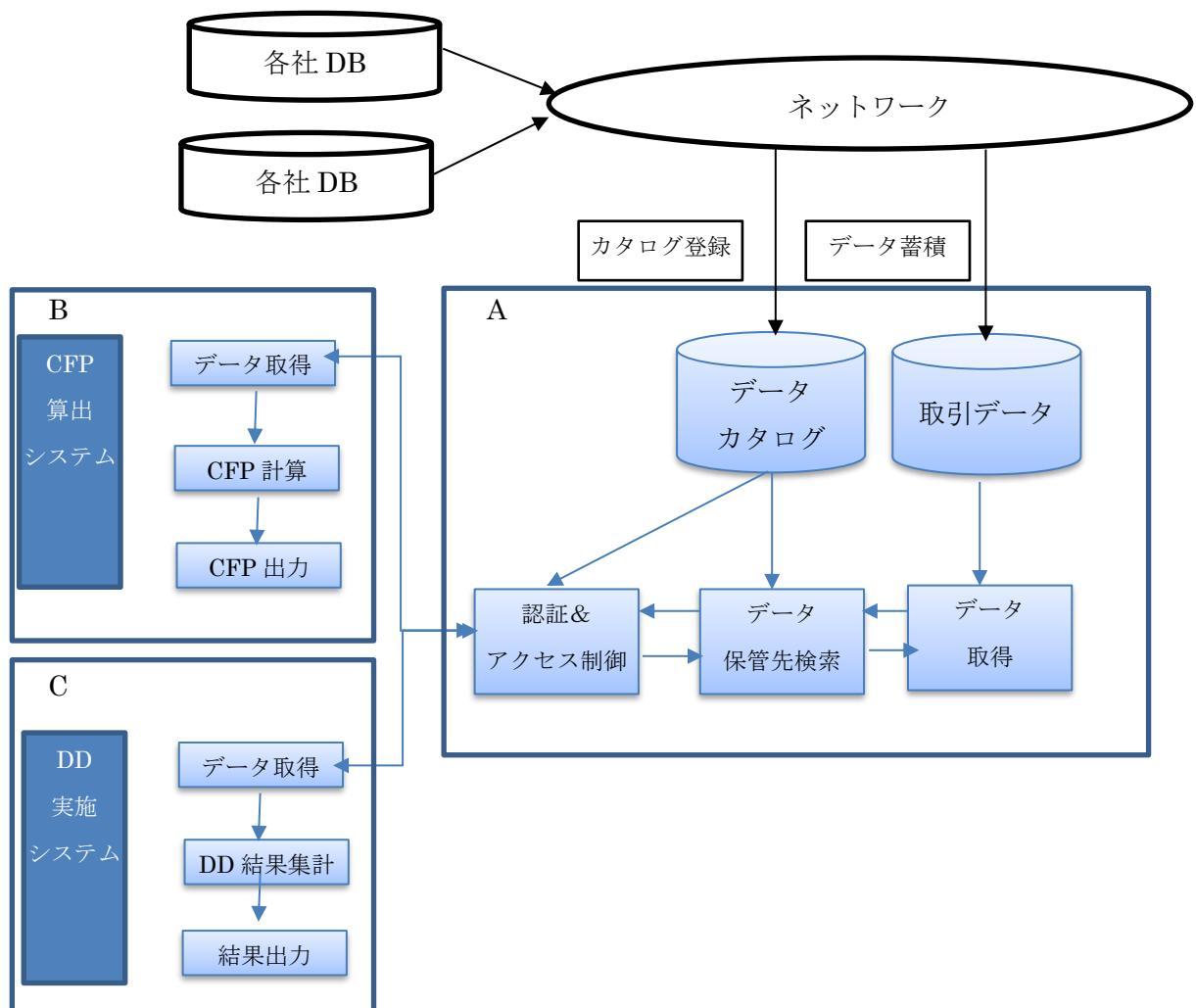
A : 蓄電池の C F P の算出、D D の実施に必要なデータのワンストップ参照を可能とするデータ蓄積／取引基盤（データ共有基盤、相互接続可能な蓄積型 E D I サービス、データ蓄積／参照H U B）
