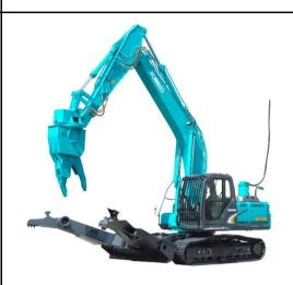
外部の電源から電力を取り込み、電動モータを駆動してその動力で油圧ポンプを駆動。油圧ポンプの油圧で、アーム、旋回、走行、ニブラ、クランプアームを作動させる。(電動マルチ解体機の場合)油圧ポンプから先の駆動は、エンジン式とまったく同じ。
