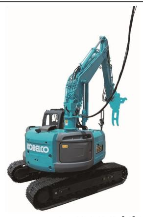
KOBELCO SK235SRD[LC]-2 電動回転フォーク仕様機
