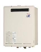
潜熱回収型業務用ガス給湯器とは、業務需要向けのガス給湯器で、従来の熱交換器に二次熱交換器を加え燃焼排ガス中の潜熱を回収して熱効率をアップさせた機器です。
