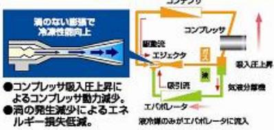
●コンプレッサ吸入圧上昇によるコンプレッサ動力減少。
