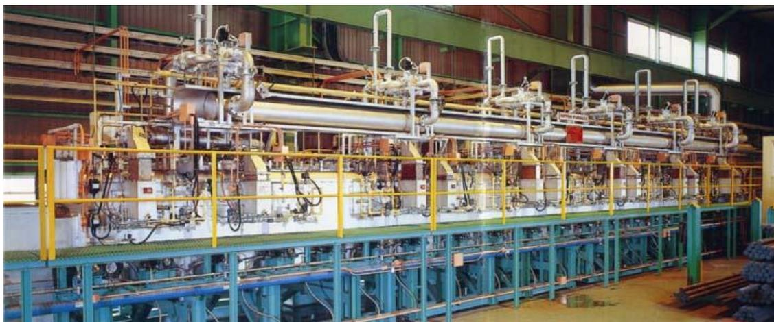
(ローラース型)熱処理炉
