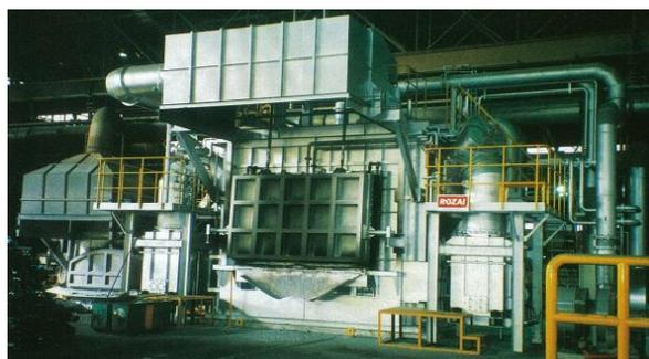
(高効率燃焼式)アルミ溶解炉
