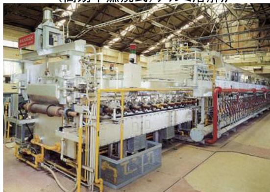
(断熱強化型)ローラーハース式熱処理
