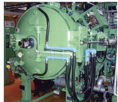
(バッチ式)脱脂焼結炉
