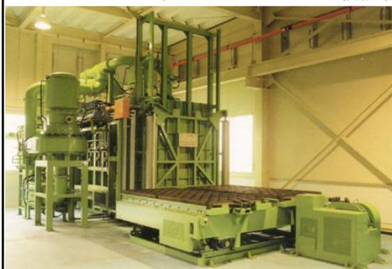
(バッチ型)光輝焼鈍炉
