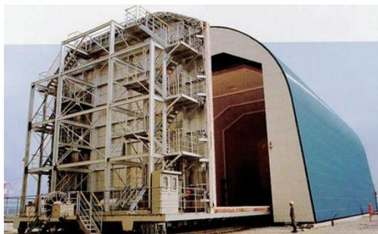
(断熱強化型)バッチ式熱処理設備
