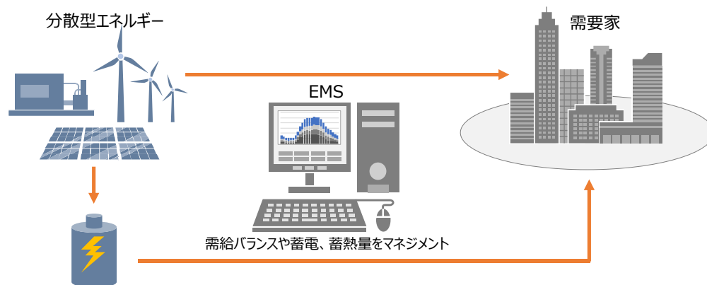
図 3-10 停電時のエネルギー供給イメージ
